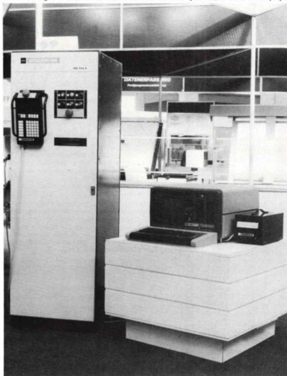
Afb. 2. Robotbesturing IRS700K van Numerik. Links de besturingskast waarop het losse teach-in paneeltje hangt, zoals op de werkvloer wordt gebruikt en rechts de Robotron microcomputer, die vooral wordt gebruikt voor het opstarten en het aanbrengen van programmatuurwijzigingen. Dit systeem is het derde computerbesturingssysteem voor robots, dat de laatste jaren door Numerik werd uitgebracht. De series beslaan minimaal tientallen systemen, die reeds in bedrijf zijn.
