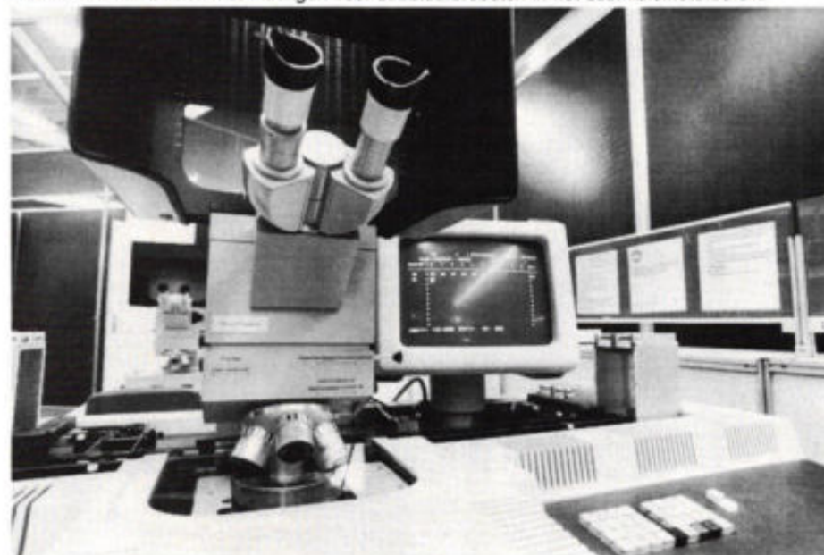
Afb. 5. Gecomputeriseerd visueel controlesysteem voor wafers bij de produktie van chips. Deze SKP02 van MKE werkt met metingen voor structuurbreedten in het submicrometerbereik.
